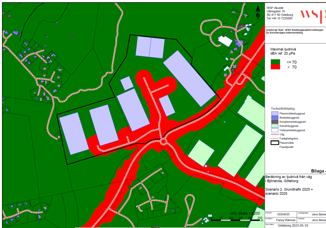
Figur 39: Beräkningar av ljudnivå från väg: maximal ljudnivå dBA (WSP).
