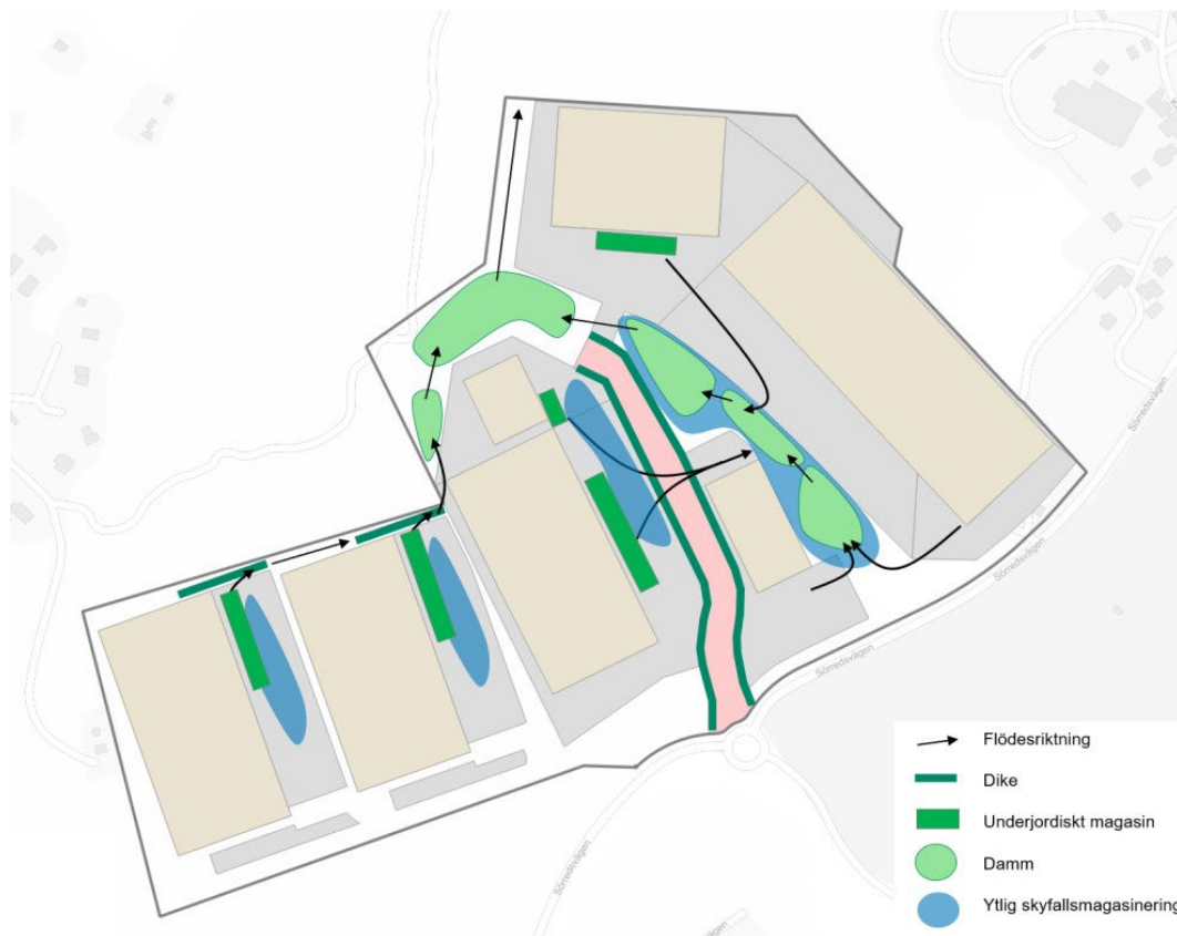
Figur 35: Principskiss över hur dagvatten och skyfallsanläggningar kan placeras för att möjliggöra erforderlig rening och fördröjning (Dagvatten- och skyfallsutredning, Kretslopp och vatten, 2023).
